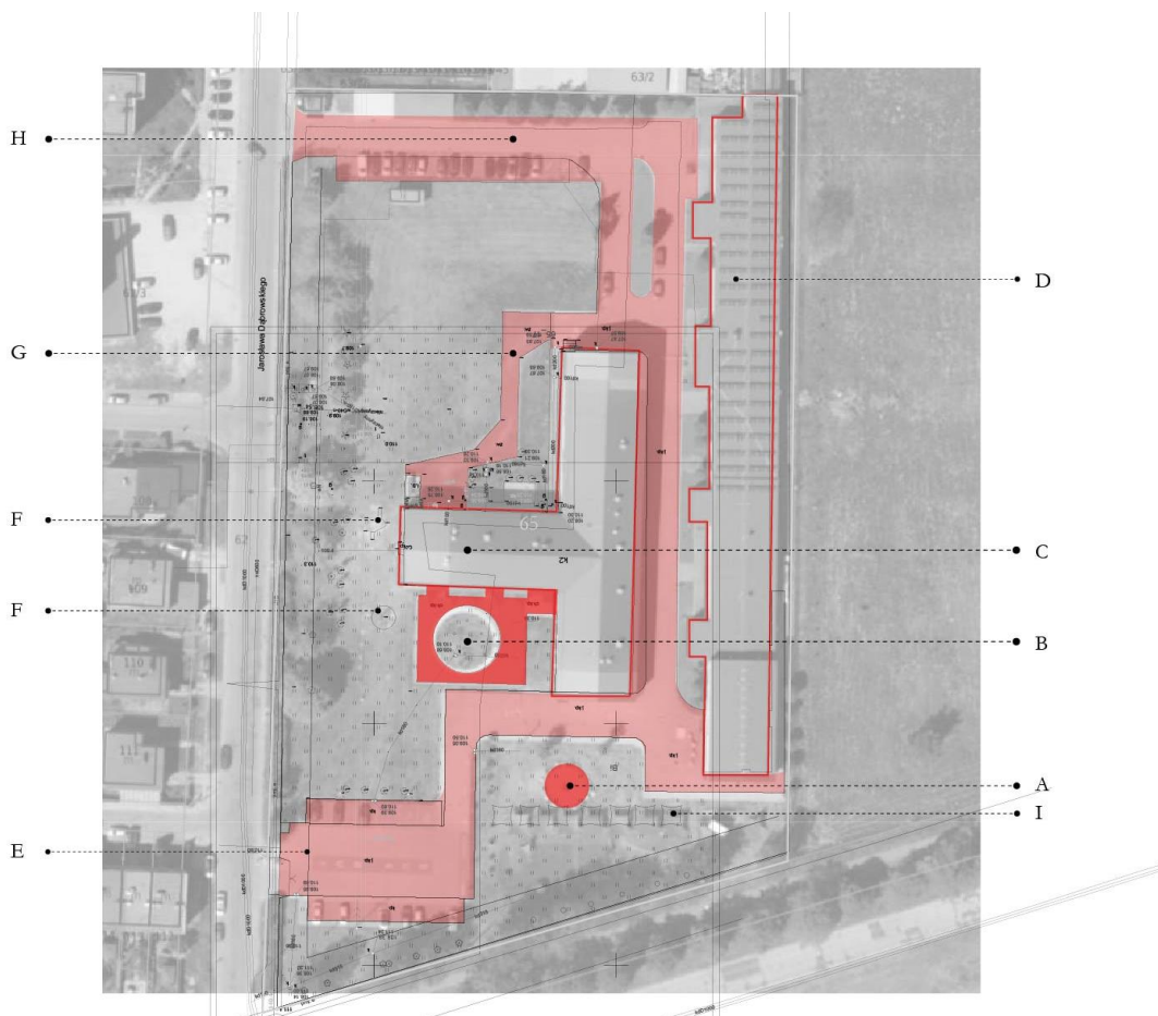
Rysunek 1. Elementy zagospodarowania działki: A – miejsce ogniskowe, B – ‘Kapsuła czasu’- plac wejściowy, C – budynek szkoły, D – Muzeum Bombki, E – parking dla autobusów, F – istniejące elementy zabawowe, G – droga pożarowa na ekokracie, H – parkingi i droga dojazdowa dla pracowników, I – zadaszania w formie żagli
